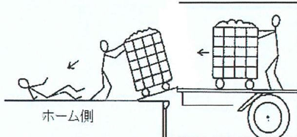
RBPに関しては、倒れそうになったら倒れる方向には入らないこと、最大積載荷重を超えた積載はしないことが求められます。また、TGLについても、昇降板等の傾きによる荷の動き出しに注意することが必要であるほか、労働安全衛生規則の改正により、TGLの操作に係る特別教育が義務付けられております。実施機関は労働基準監督署へお問い合わせください。
